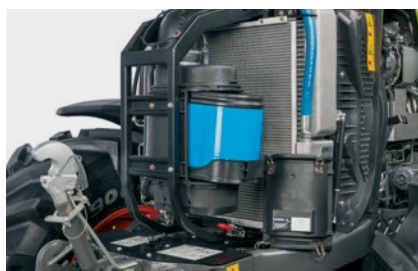
Le filtre à air du moteur se trouve devant le radiateur et il est facile à atteindre depuis le sol.
