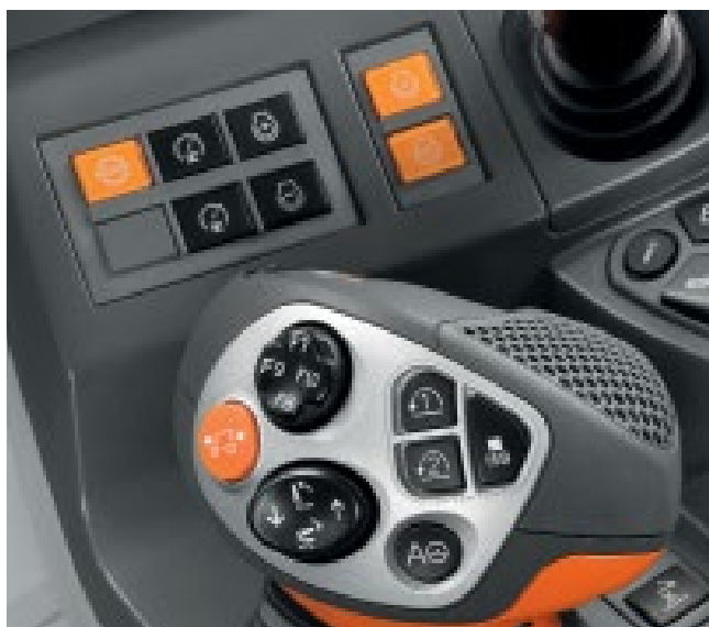
Chute de régime autorisée pour les modes « Eco » et « Power », et mémoire du régime moteur.
