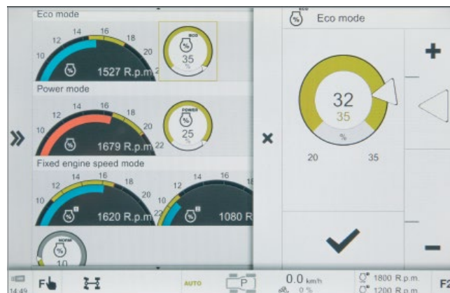
Chute de régime autorisée pour les modes « Eco » et « Power », et mémoire du régime moteur.
