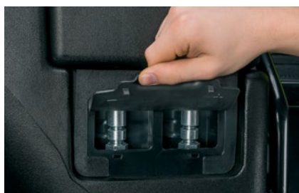
Les bornes de la batterie externe sont facilement accessibles au niveau du marchepied gauche de la cabine.
